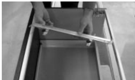
Ruotare la trafilina di alcuni gradi.
