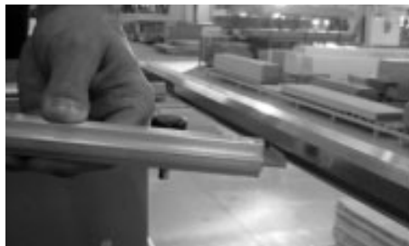
Inserire la trafilina nella apposita sede.
