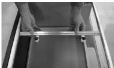
Portare la trafilina parallela al fianco.
